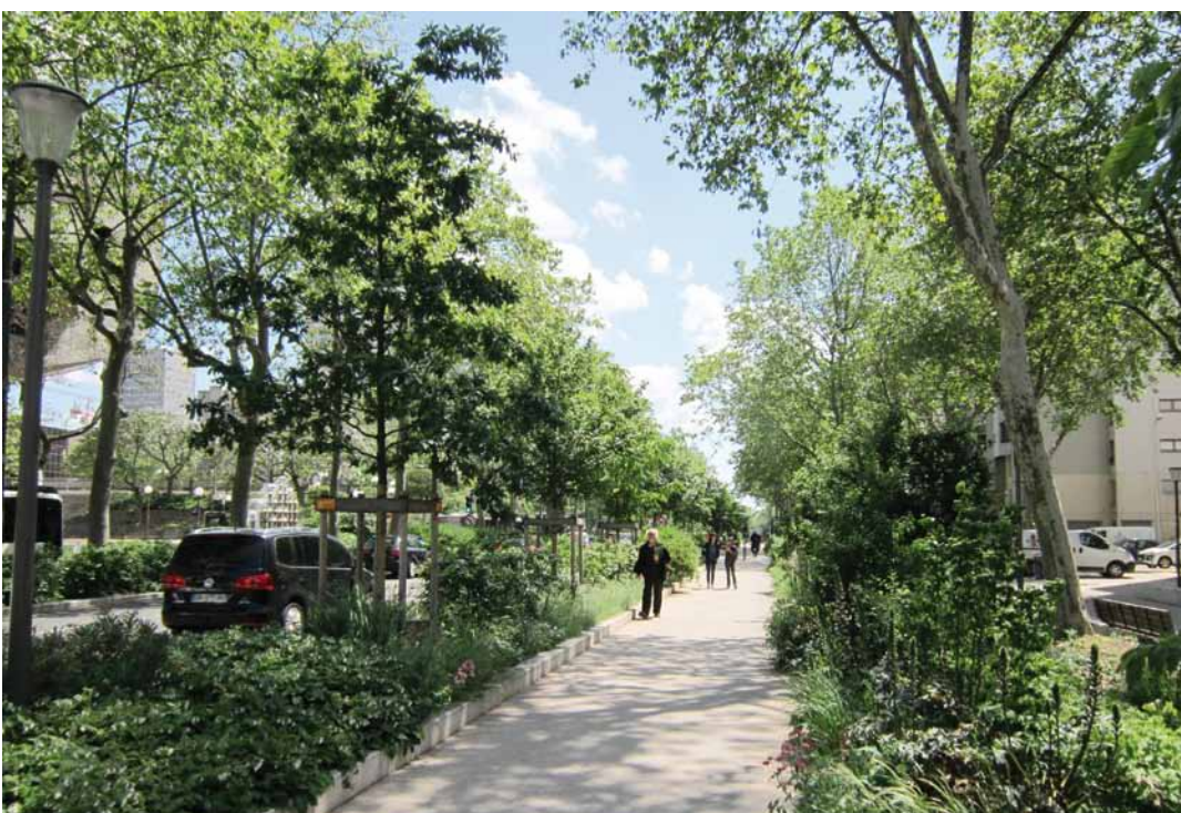
Une expérience pilote de rafraîchissement de la ville menée dans le cadre du réaménagement de la rue Garibaldi à Lyon : 3 strates de végétation pour un effet climatiseur et un dispositif de récupération des eaux de pluie non polluées.
